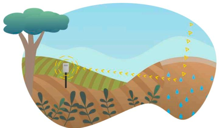
Figura 2. La sonda FINAPP mide neutrones formados por la interacción entre los rayos cósmicos y el agua.
